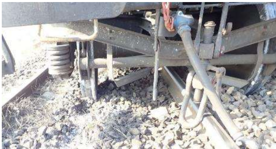
Foto nr.1 – Al doilea boghiu deraiat în sensul de deplasare
