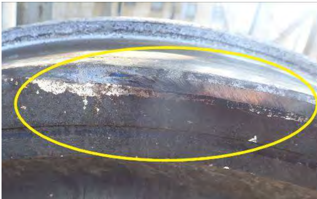
Foto nr.2 – urma de lovire a părții care ține loc de bandaj, cu afectare termică
