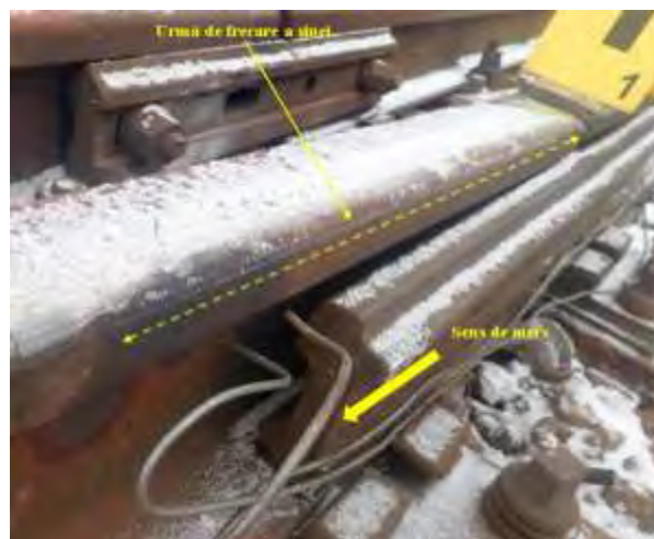
Foto nr. 13 – Eclisă lovită, urmă de frecare a șinei Foto nr.14 – Urmă de frecare a șinei
