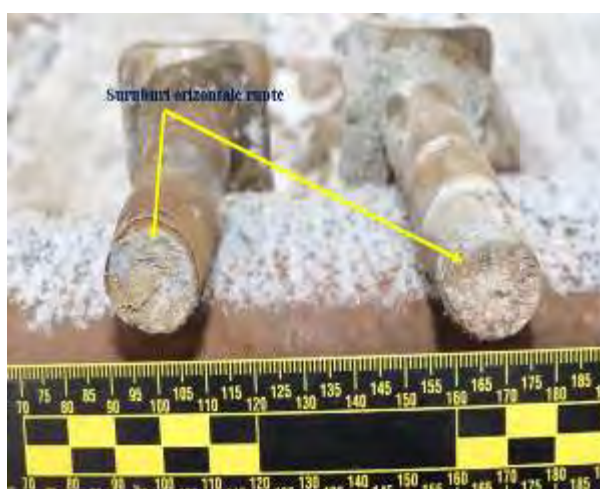
Foto nr.35 – Șuruburi orizontale rupte la punct „0”.
