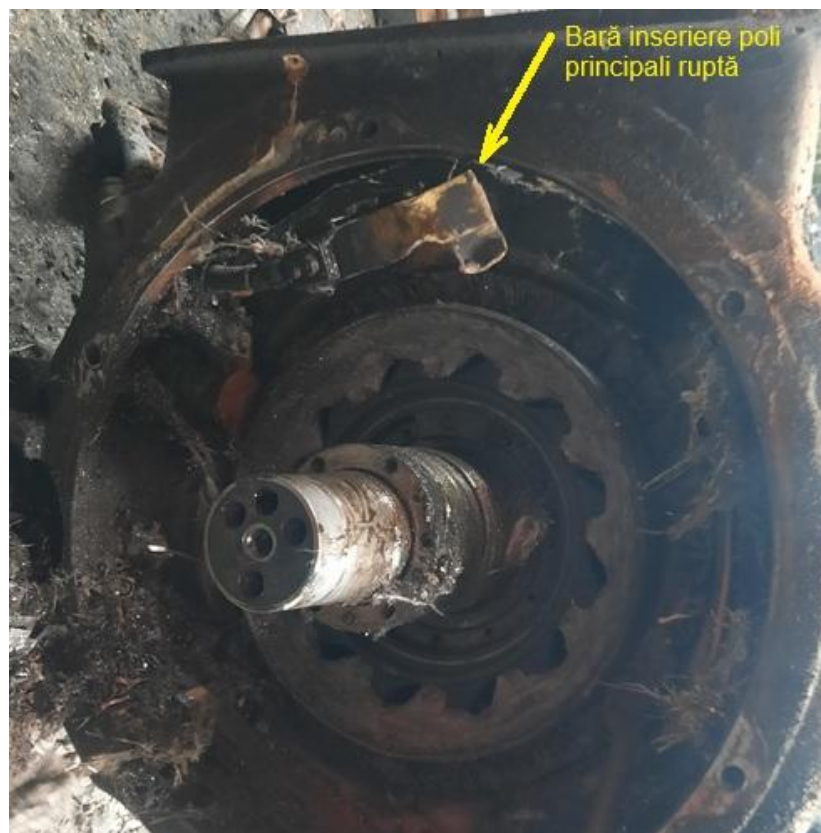
Foto nr.2 Motorul de tracțiune nr.4 demontat (vedere din partea opusă colectorului)
