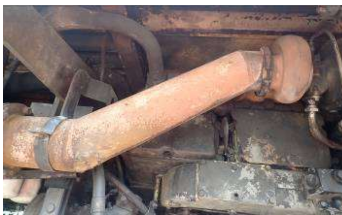
Foto nr.8 – galeria de evacuare gaze arse
