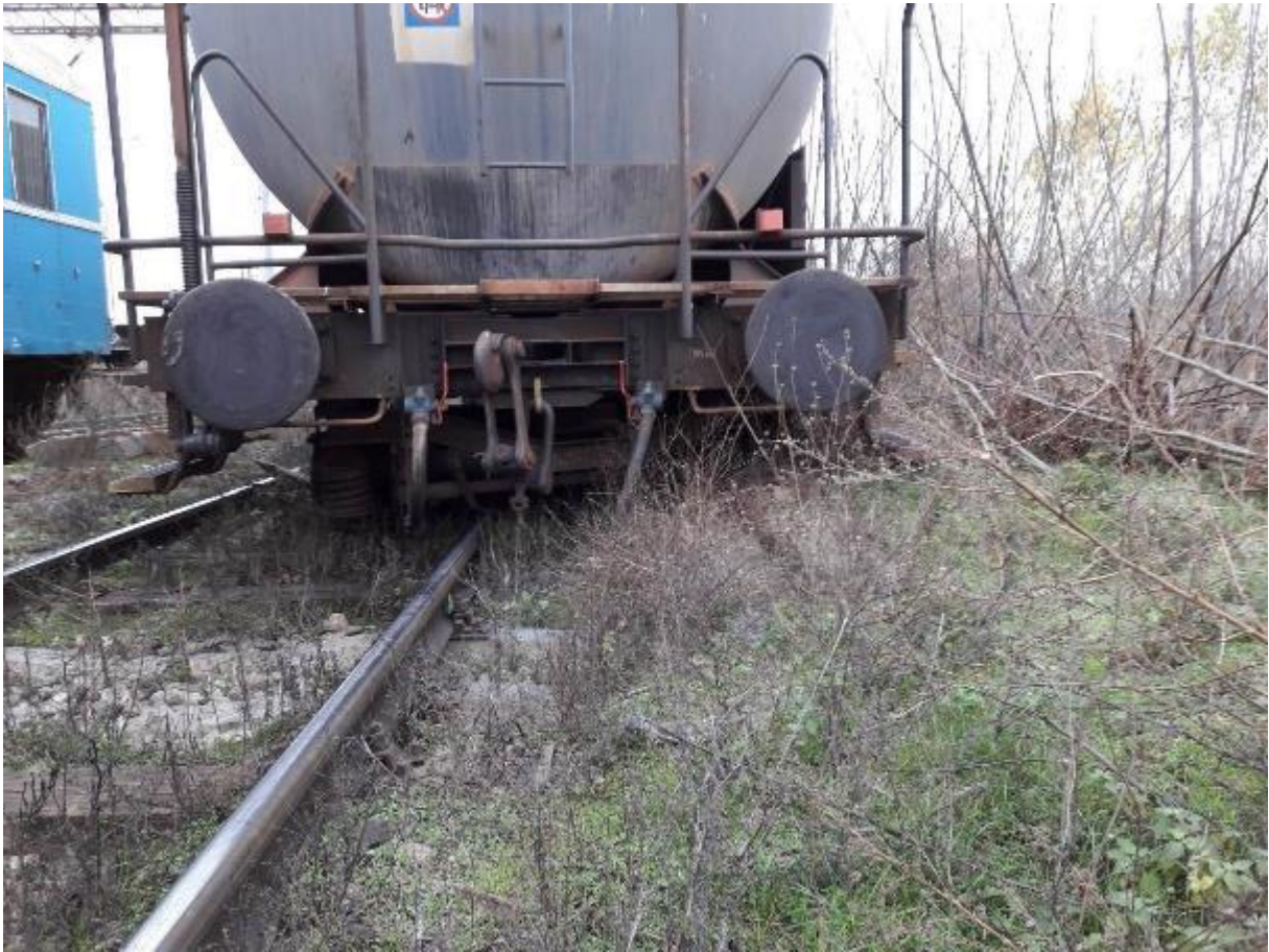
Foto 1 Primul boghiu în sensul de mers la vagonului deraiat
