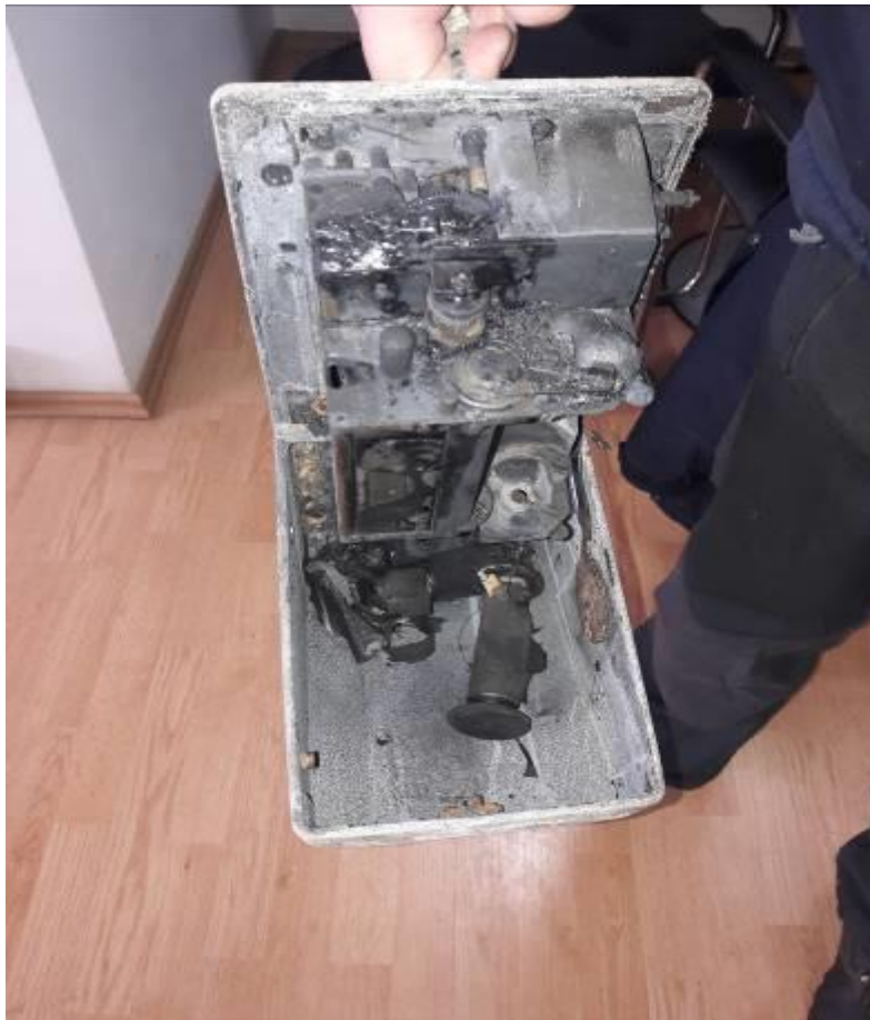
Foto nr.8 – vitezometrul degradat
