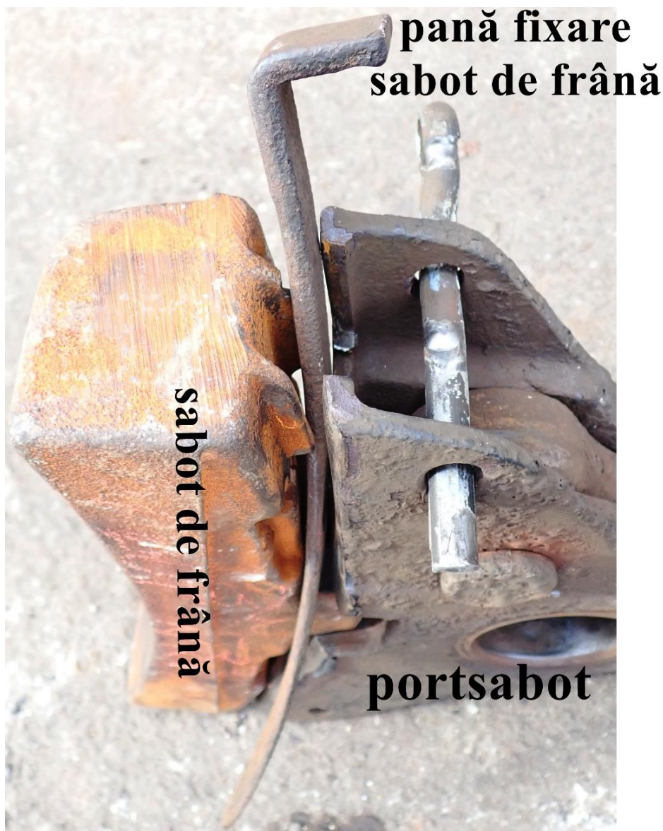
Foto nr.4 – ansamblu sabot de frână – portsabot având pana de fixare introdusă între cele două
