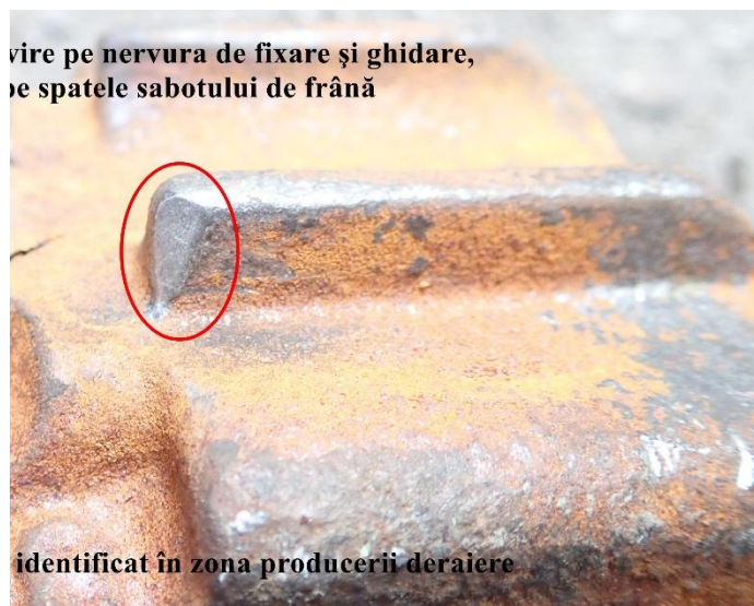
Foto nr.2 - urmă de lovire pe nervura de fixare și ghidare a sabotului de frână identificat în zona producerii deraierii
