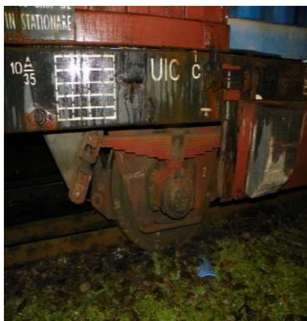
foto nr.1, 2: vagoanele în stare deraiată
