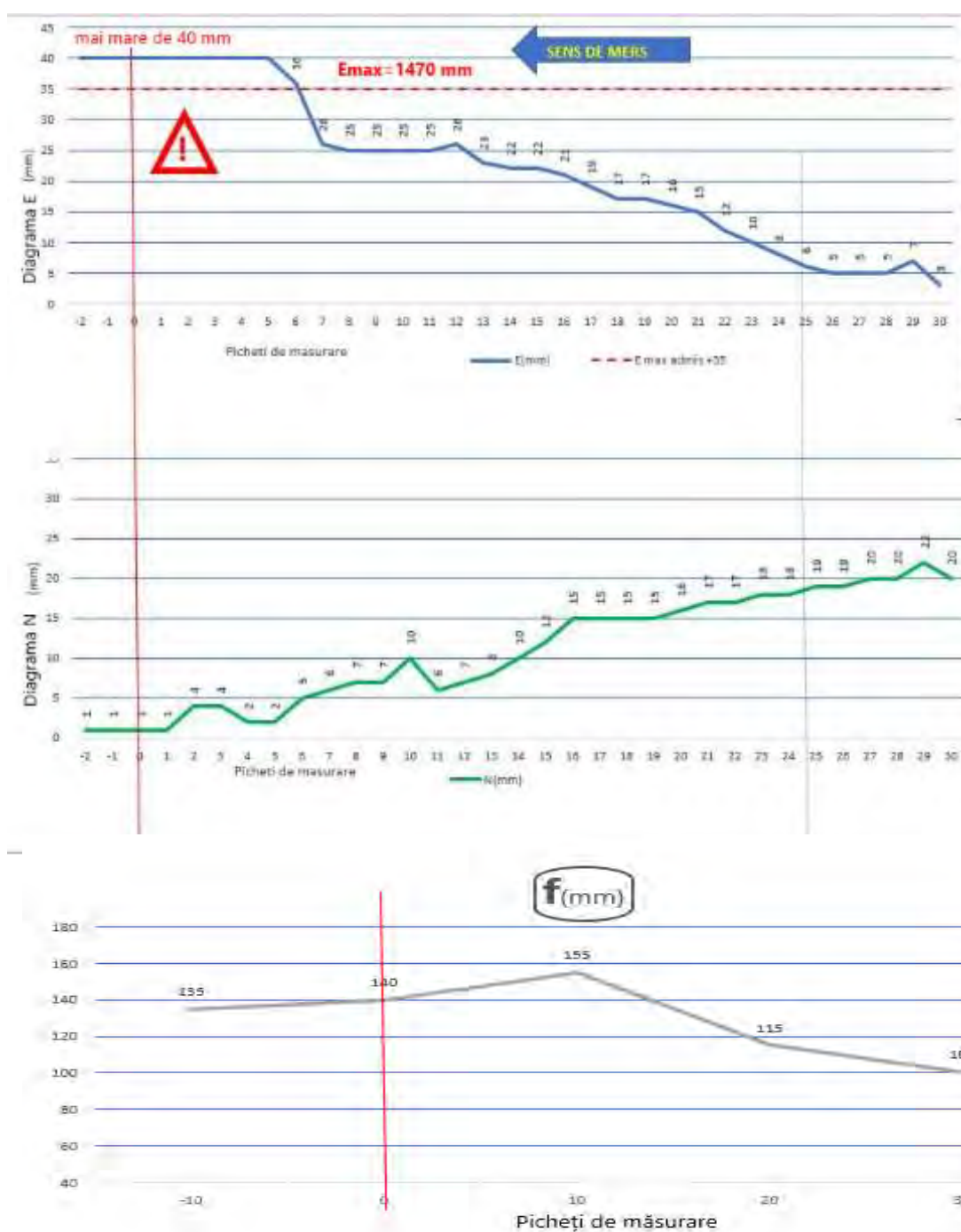
Imaginea nr. 11 – Diagrama ecartamentului, nivelului transversal și al săgeților
