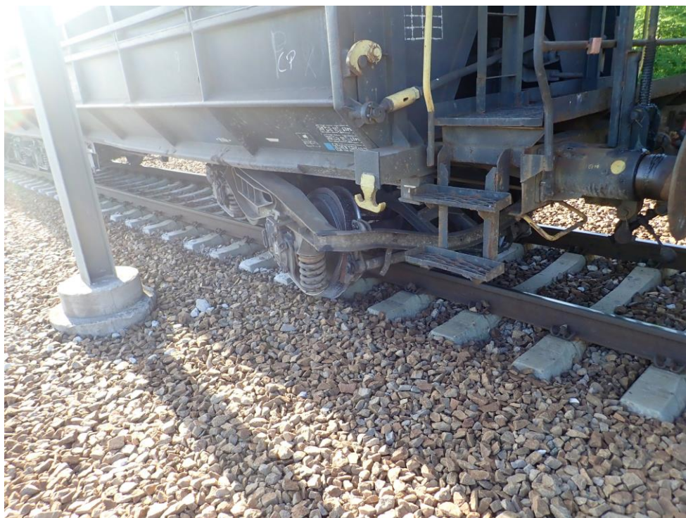
Fotografia nr. 1 – vagonul deraiat pe linia III din stația Valul lui Traian
