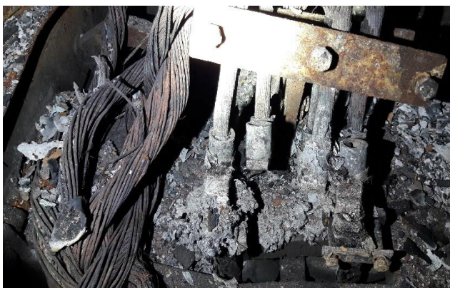
Foto nr. 23 stare existentă a jugului de fixare a cablurilor la intrarea în motorul de tracțiune
