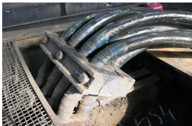
Foto nr.24 stare normală a jugului de fixare a cablurilor la intrarea în motorul de tracțiune
