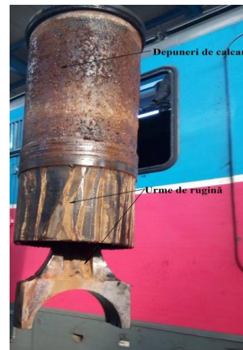
Fig. nr.7 Pistonul și cămașa cilindru nr.5
