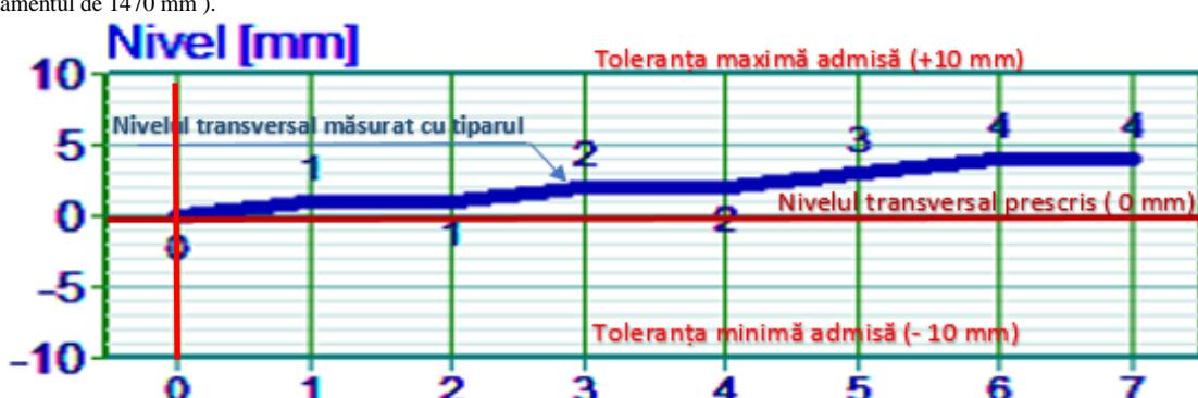
Figura nr. 6 - Diagrama nivelului transversal măsurat
