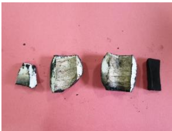
Imaginea 8 – fragmente din izolatorul spart
