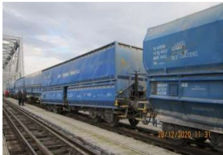
Foto nr.6 Poziția osiilor in exteriorul căii de la vagonul al 17-lea de la locomotivă
