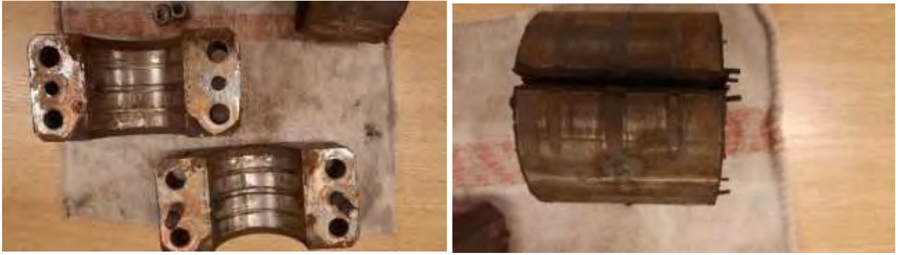
Foto nr. 3 Clemele de fixare ale barei de torsiune pe boghiu și elementul de cauciuc
