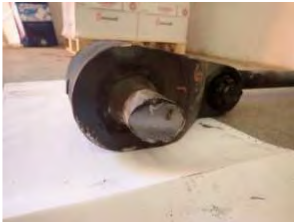
Foto nr. 2 – Suprafața de rupere a barei de torsiune
