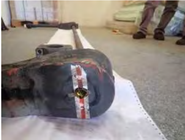
Foto nr. 1 - Marcajele de control de pe brațul ansamblului antiruliu
