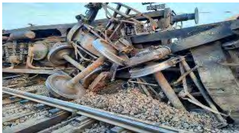
Foto nr.1 - Vedere laterală a boghiurilor deraiate a vagoanelor nr.84539305145-1 și nr.84539305331-7
