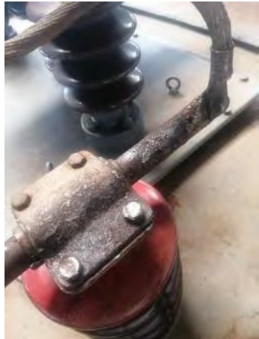
Foto nr. 1 - urme de arc electric de pe capătul barei de tensiune, legătura flexibilă, clema și șuruburile de strângere a barei de tensiune
