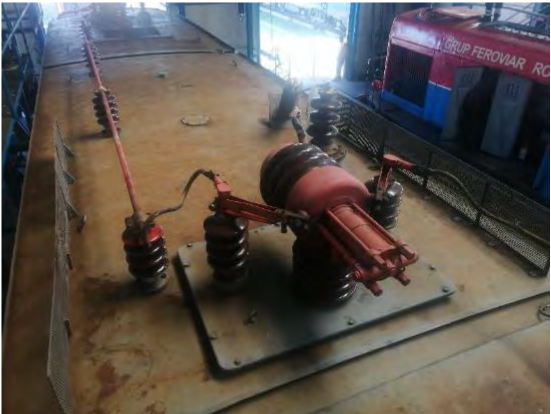
Foto nr. 3 - imagine de ansamblu a în dreptul primului izolator de susținerea al barei de tensiune care face legătura dintre disjuncteur și pantograful nr.2
