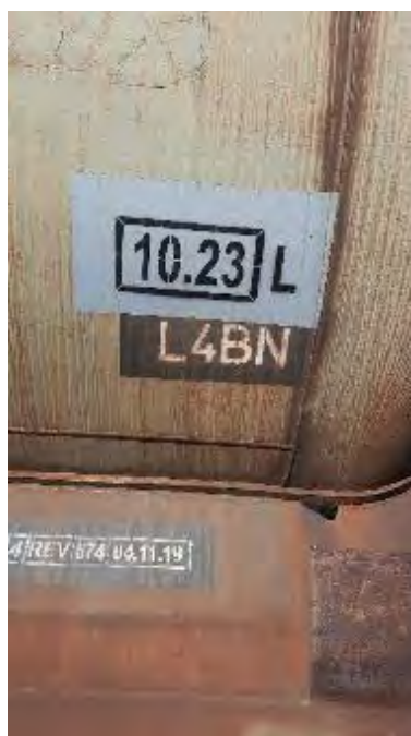
Foto nr. 5 - inscripțiile pe vagon care atestă tipul recipientului și data efectuării verificării tehnice periodice
