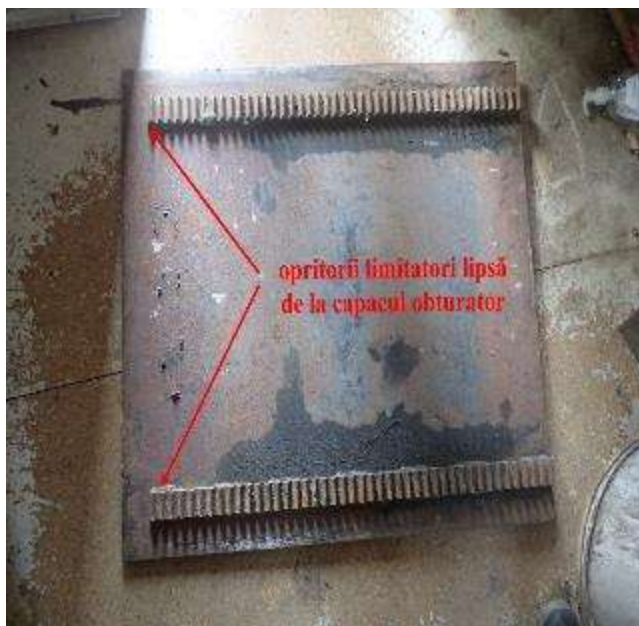
FOTO nr.7, opritori limitatori lipsă de la capacul obturator de la a treia gură de golire
