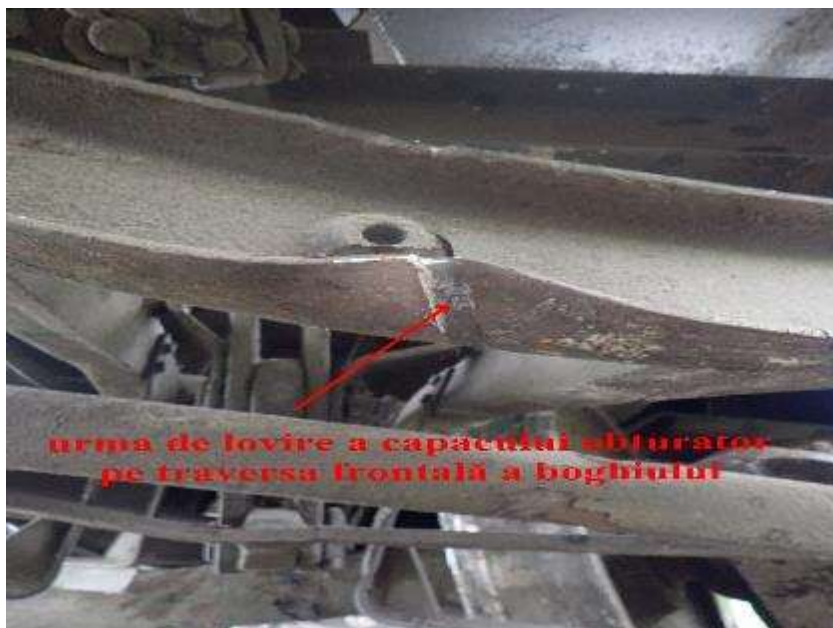
FOTO nr.10, urma de lovire a capacului obturator pe traversa frontala a boghiului
