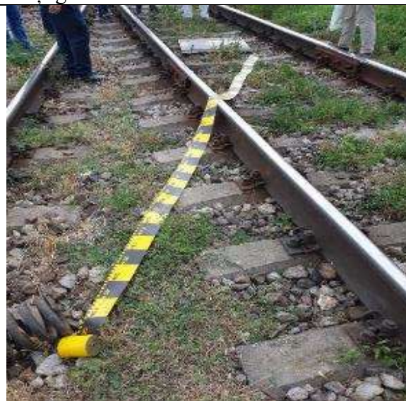
FOTO nr.5, primul arc elicoidal de suspensie, căzut la 4,50m față de capacul obturator
