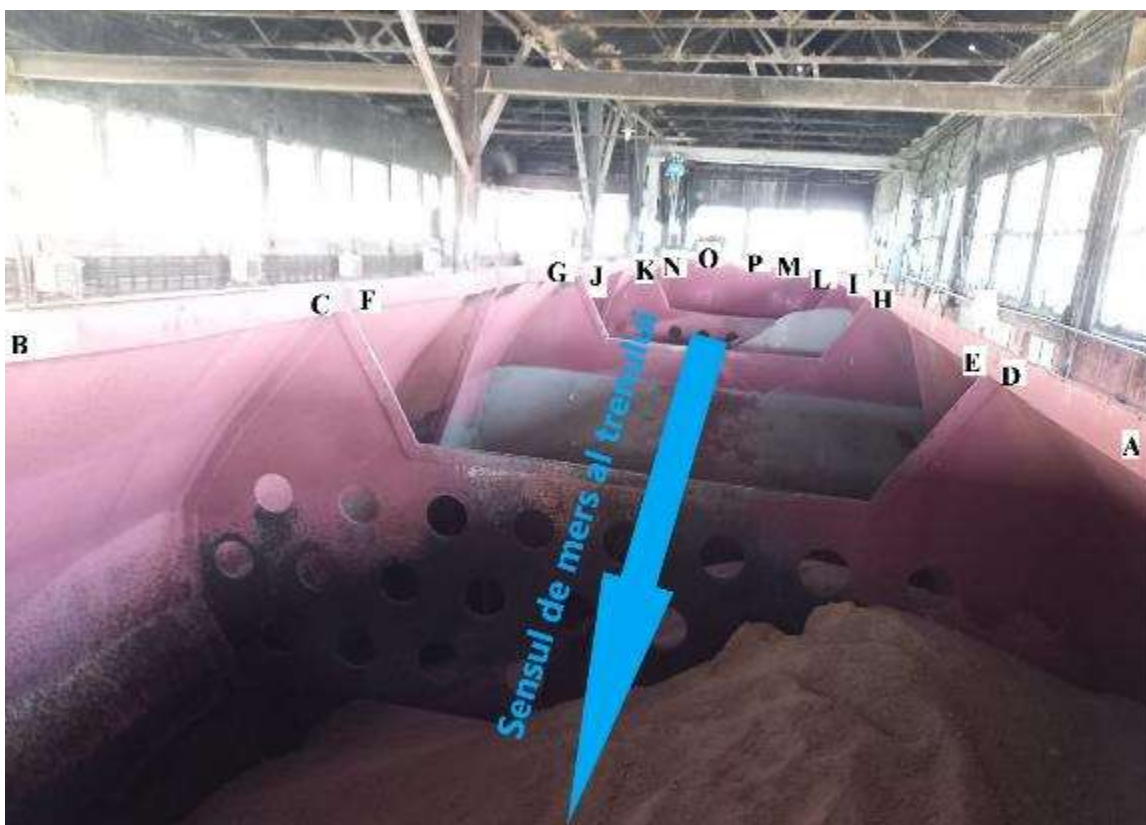
Foto nr.1 - starea încărcăturii în vagon cu punctele de măsurare a înălțimii mărfii
