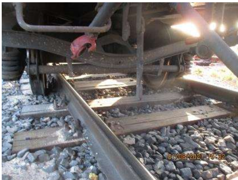
Foto nr.3 - poziția osiei deraiate
