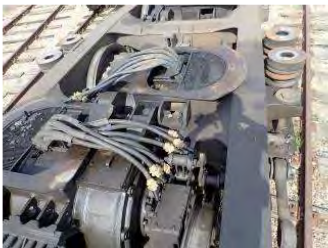
Foto nr. 9 - boghiul II, motoarele de tracțiune neafectate termic
