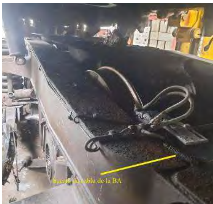
Foto nr.15 - Bucată de cablu cu tubul flexibil de protecție, căzută pe rama boghiului I, provine din zona de traversare la blocul S7
