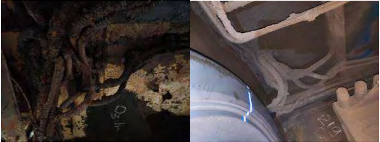
Foto 12 și 13 - locul de traversare a cablurilor electrice, la locomotiva EA 251, în comparație cu o locomotivă din exploatare
