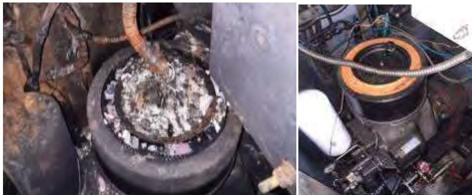
Foto nr. 5 și 6 - filtru de aer al compresorului afectat termic în comparație cu un filtru neafectat
