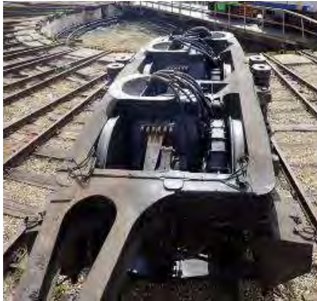
Foto nr.7 - boghiul nr. I , se observă materialul topit căzut din cutia locomotivei, motoarele de tracțiune fiind neafectate termic
