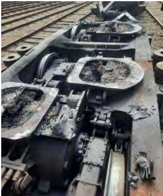
Foto nr. 8 - boghiul nr. II, motoarele de tracțiune fiind neafectate termic
