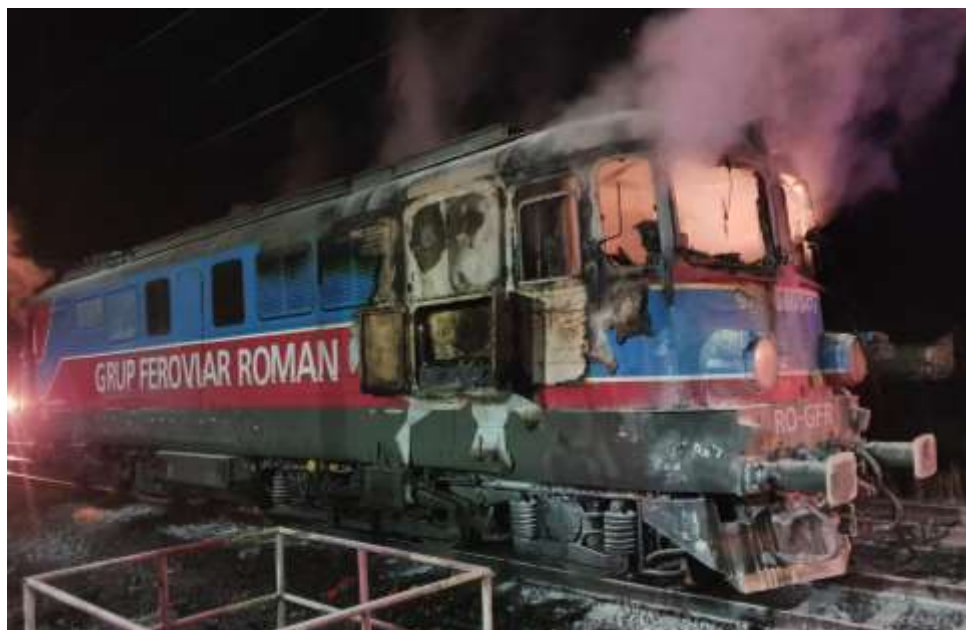
Foto nr.1 Locomotiva DA1547 situată la km 49+908, locul declanșării incendiului
