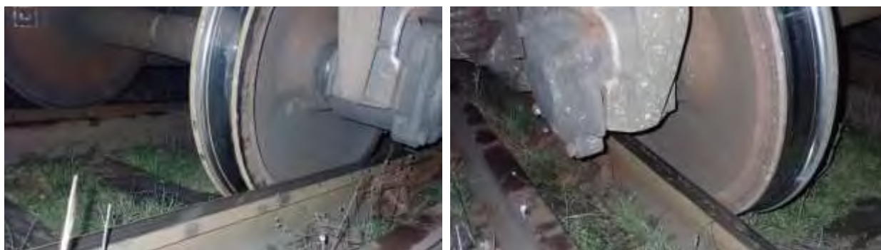
Foto nr.4 - vagonul nr.67846618 - după deraiere
