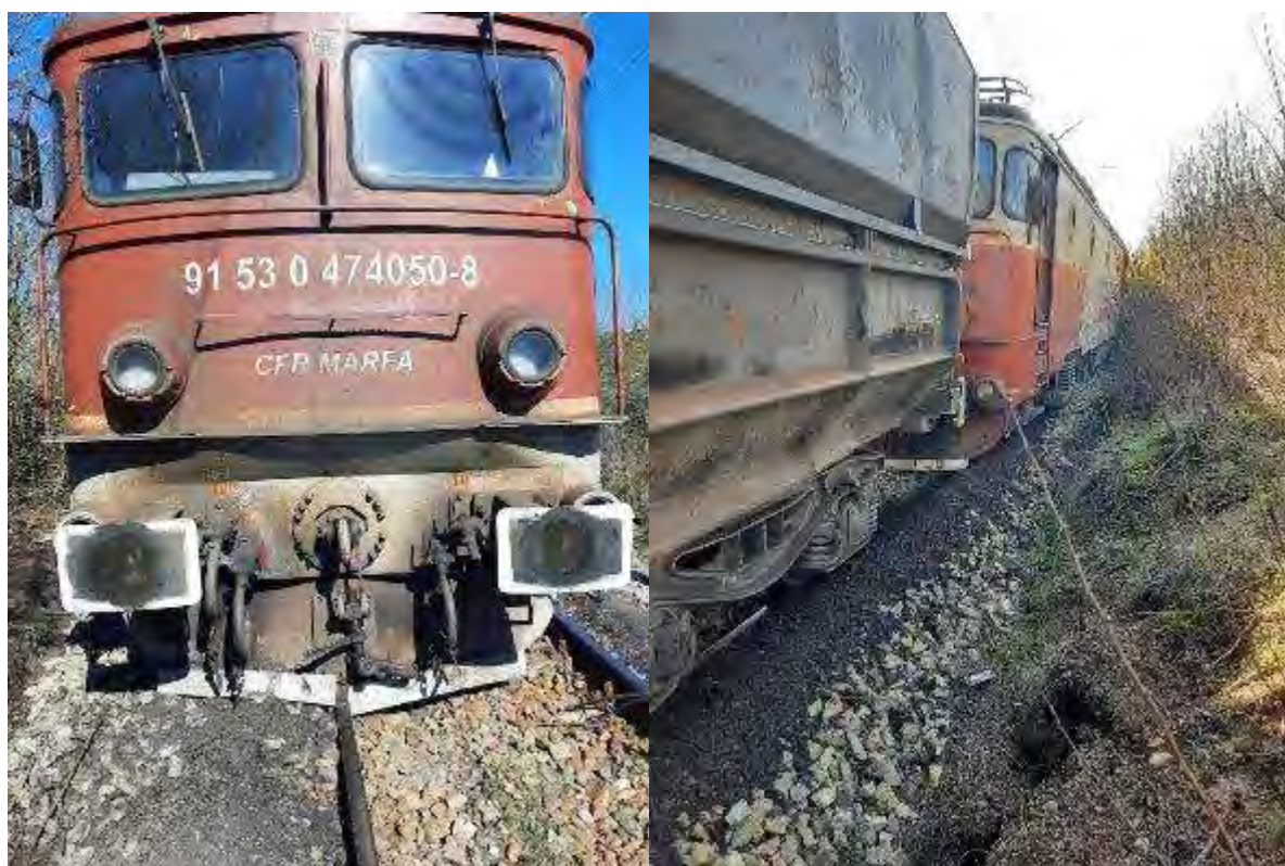
Foto nr. 1, Locomotiva ED 050 deraiată de toate osiile
