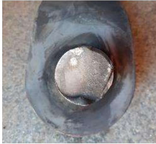
Foto nr. 2 – Suprafața de rupere a barei de torsiune
