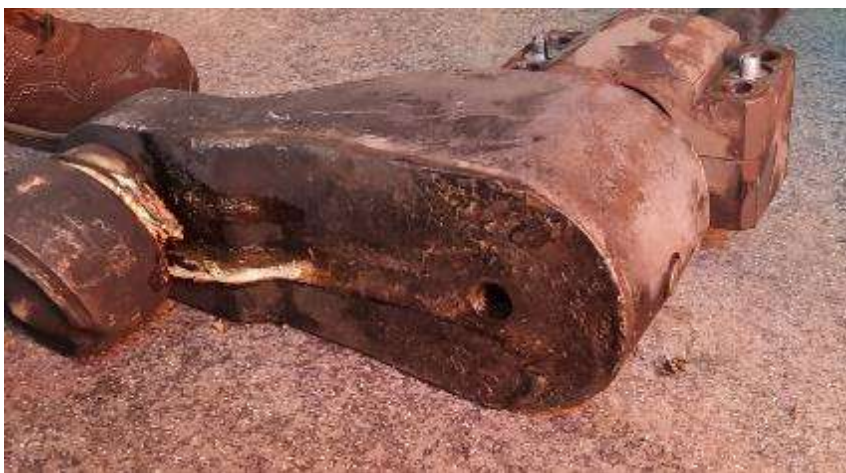
Foto nr. 1 - Marcajele de control de pe brațul ansamblului antiruliu dinspre partea zonei de rupere
