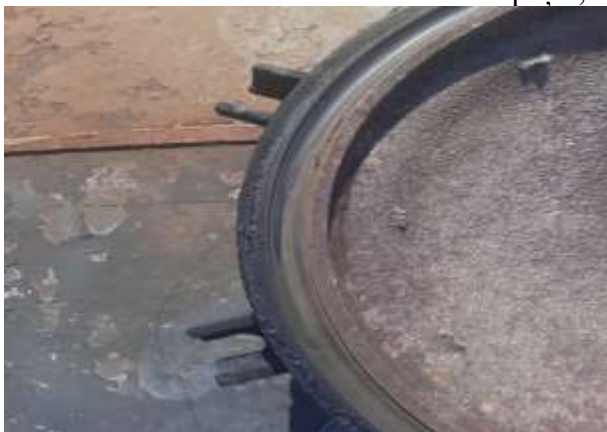
Foto nr. 6 - urme ușoare de carbonizare pe o lungime de cca. 15cm la exteriorul garniturii
