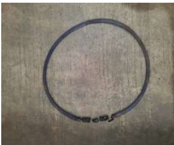
Foto nr. 9 - garnitura de cauciuc a capacului domei de încărcare era afectată termic
