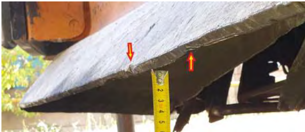
Imaginea nr. 14 – apărătorul de animale cu zgârieturi/știrbituri
