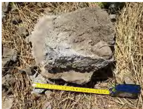
Imaginea nr.33 -deșeu provenit din demolări de construcții, găsit la baza rambleului în zona producerii impactului
