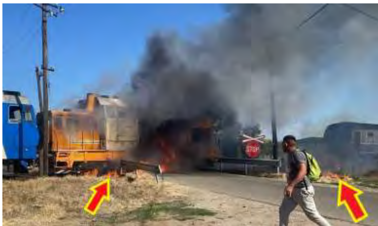
Imaginea nr.28 – flacără pe terasament lângă locomotivă și spre urma trenului (foto efectuată de martor ocular)
