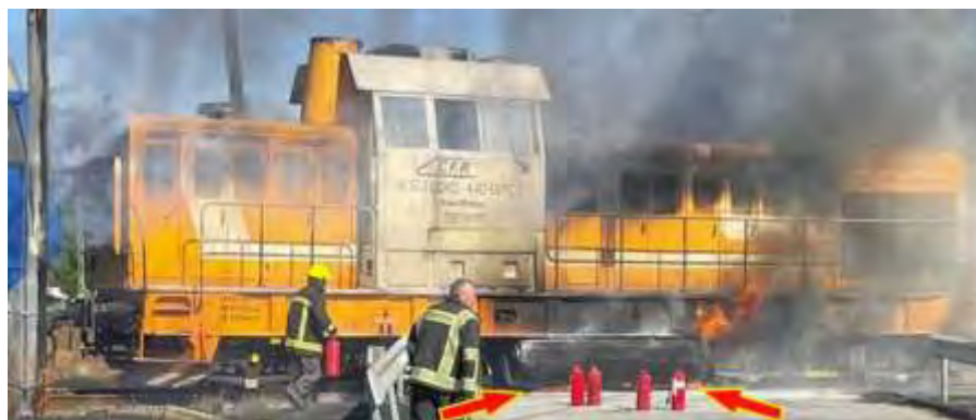
Imaginea nr.31 – în acest timp motorina ardea sub rezervor (imagine martor ocular)
