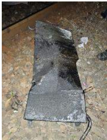
Foto nr.2: Rezervorul colector de reziduuri
