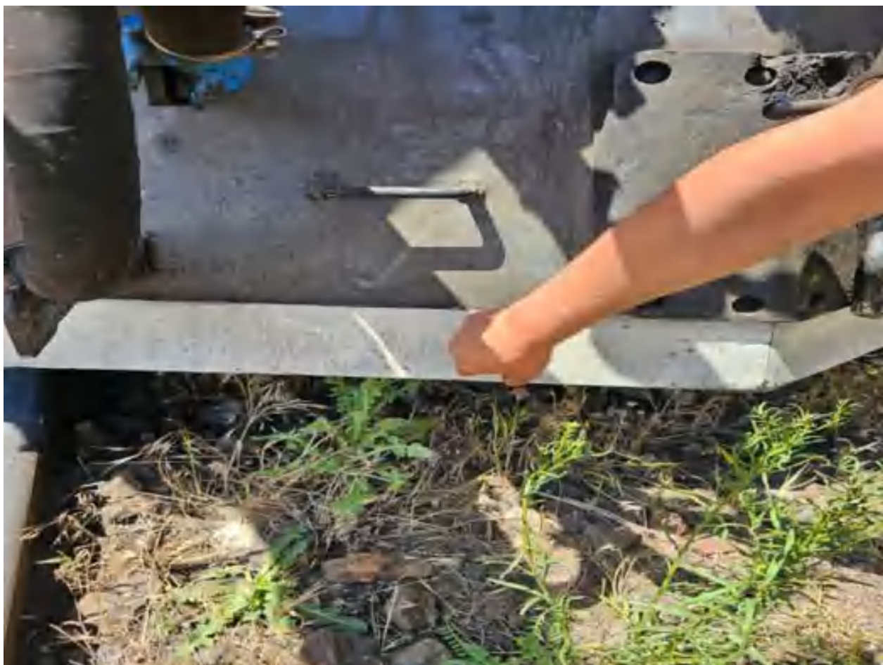
Foto nr.3 – zona unde plugul locomotivei DA 1680 a lovit piesa metalică
