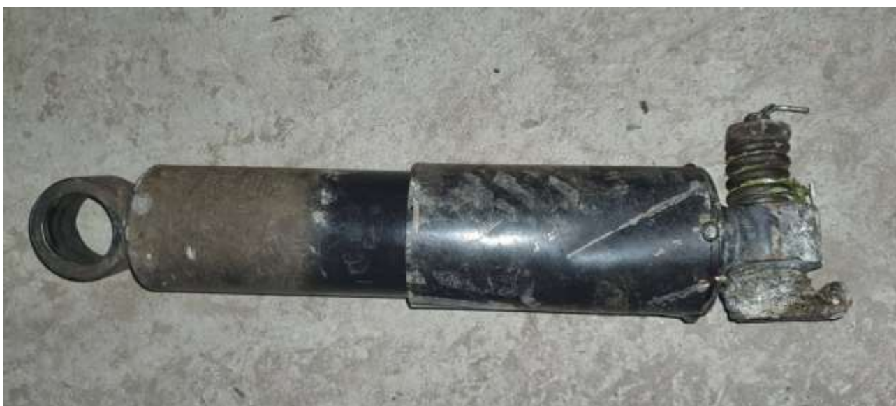
Foto 2. amortizorul vertical demontat de la osia nr. 3 partea dreaptă a locomotivei
