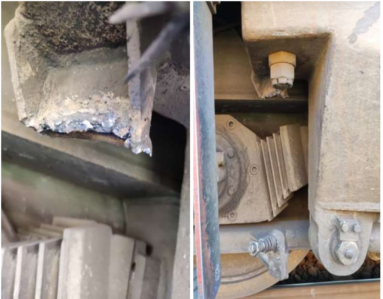
Fota 4. Suportul rupt de pe cutia locomotivei
