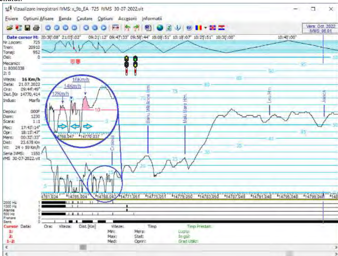
Fig.3 Imagine a benzii de vitezometru de la locomotiva EA 725 – plecare din stația Craiova, oprire, darea trenului înapoi și iar plecare cu înregistrarea vitezei de 16 km/h.
