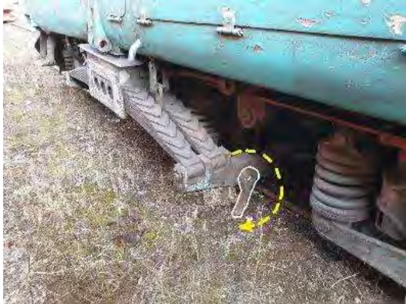
Imaginea 11 – Unul dintre brațele rupte ale bridei pendulare, s-a rotit înspre inductorii din cale (exemplu)
