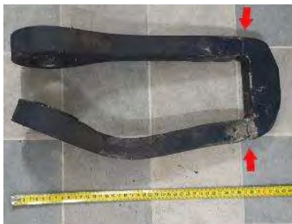
Imaginea 7 – cele două secțiuni de rupere ale bridei pendulare
