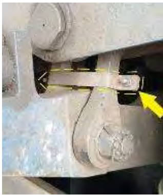
Imaginea 12 – piesă de siguranță aplicată pe brida pendulară (model)
