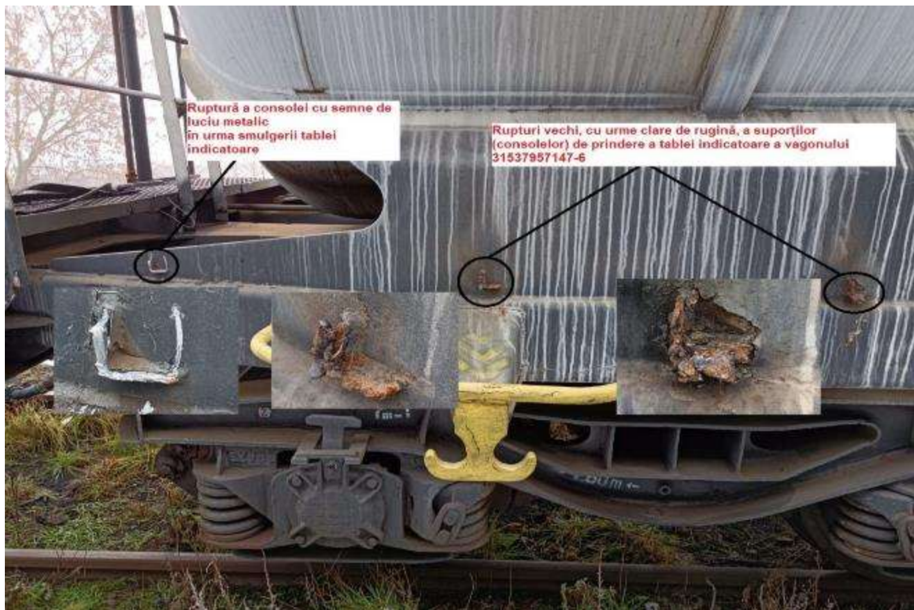
Foto nr.6- punctele de prindere a tablei indicatoare
