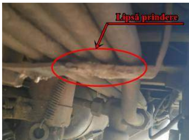
Foto nr.6 Locul unde nu a avut prindere prin sudură
