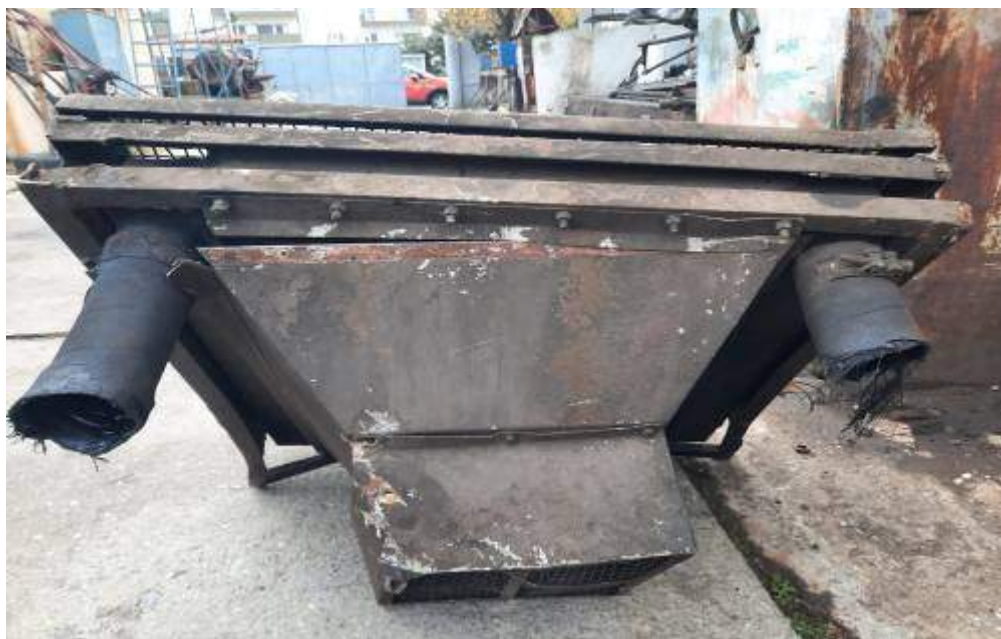
Foto nr.5 Radiatorul desprins din sudură
