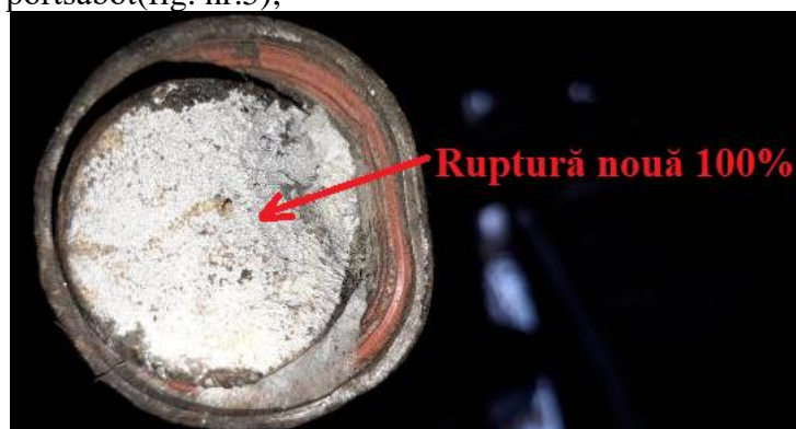
Fig. nr.5 – Tija de reglaj RL2-350 osia nr.4 cu ruptură nouă în proporție de 100%
