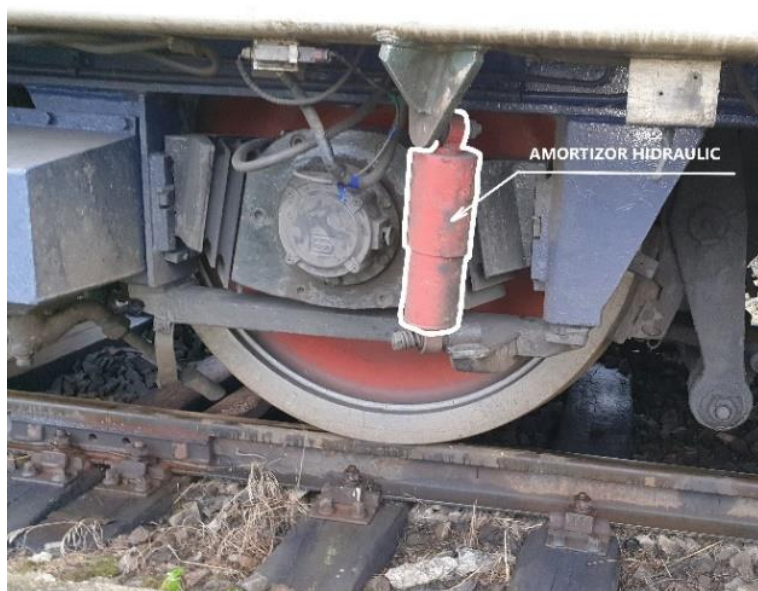
Imaginea 1 – exemplu de amortizor hidraulic vertical (în poziție normală de funcționare)
