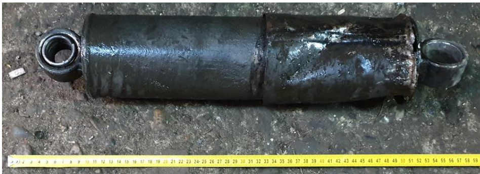
Imaginea 5 – amortizorul hidraulic vertical, osia 6 partea dreaptă era demontat și prezenta urme de lovituri.
