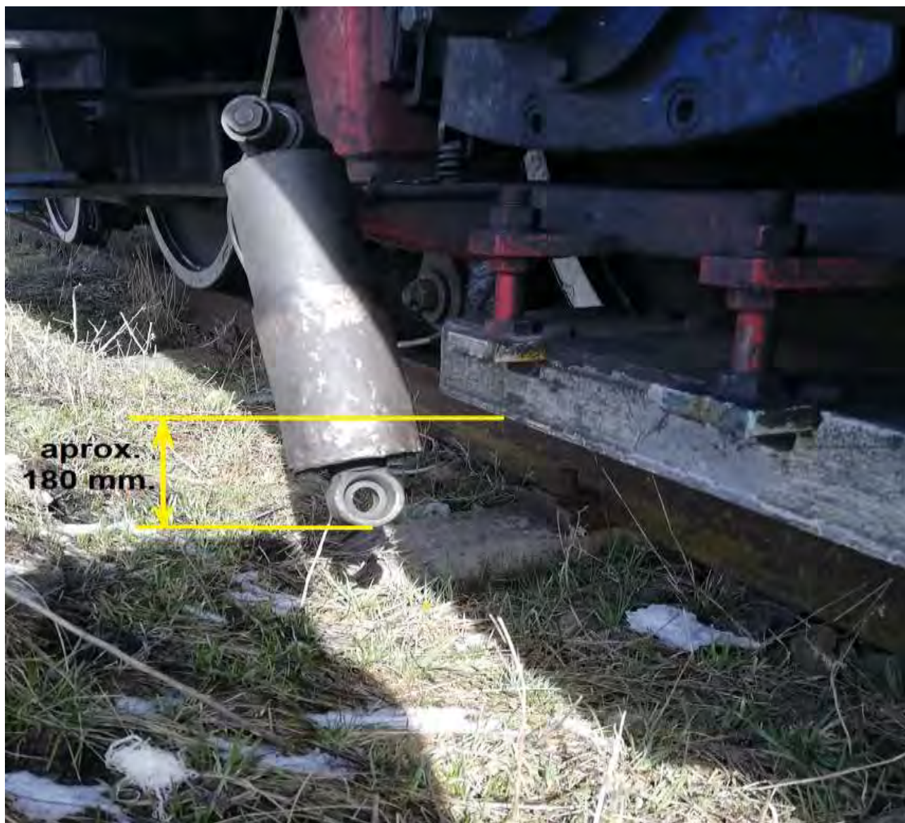
Foto nr.7 – Probe și măsurători efectuate cu amortizorul desprins din urechea superioară, cu rotirea acestuia în plan vertical și intrarea în gabaritul pentru elemente ale instalațiilor feroviare
