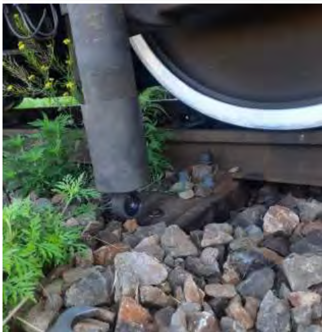
Foto nr.10 – Probe cu amortizorul desprins din urechea superioară, cu intrarea acestuia în gabarit
