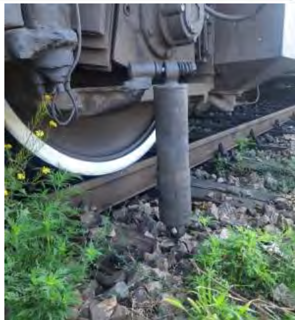
Foto nr.10 – Probe cu amortizorul desprins din urechea superioară, cu intrarea acestuia în gabarit
