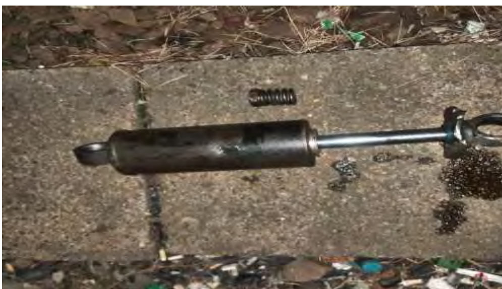
Foto nr.2 – Amortizorul desprins, a fost depozitat în postul de conducere. Foto realizată în stația CFR Iași, la sosirea trenului de călători nr.1834 din 23.06 2021;
