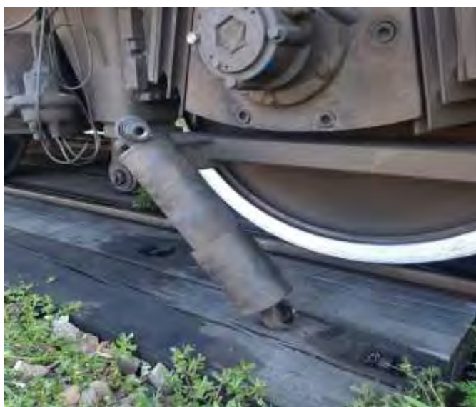
Foto nr.11 – Distanțarea capătului desprins al amortizorului prin balans în plan transversal
