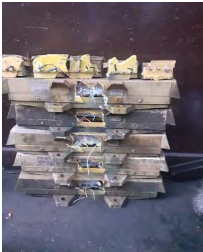
Foto nr.12 – Inductorii cu carcusele distruse prin smulgerea (spargerea) plăcilor de borne
