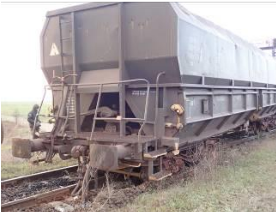
Vagonul nr.33536651544-3, deraiat de al doilea boghiu
